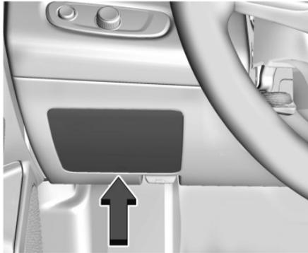
La caja de fusibles del tablero de instrumentos se encuentra en el lado inferior del tablero de instrumentos del lado del conductor. Para tener acceso a los fusibles, remueva el compartimento de almacenamiento. Para remover el compartimento de almacenamiento, abra el compartimento y extráigalo.
