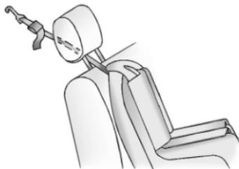
Si la posición que está utilizando tiene un apoyacabezas o un soporte de cabeza y está utilizando sólo una atadura, pase la correa por debajo de la cabecera o del apoyacabezas así como entre las barras de la cabecera o del apoyacabezas.
