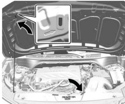
3. Levante el cofre y libere la varilla del cofre de su retenedor, encima del radiador. Coloque firmemente el soporte del cofre dentro de la ranura en la parte inferior del cofre.
