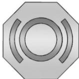
El depósito del cilindro maestro de frenos se llena con líquido de frenos DOT 4 aprobado por GM, como se indica en el tapón del depósito. Vea en *Vista general del compartimiento del motor* ⇨ 213 la ubicación del depósito.
