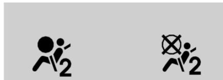
Los símbolos del indicador de estado de la bolsa de aire del pasajero se iluminarán por varios segundos como una verificación del sistema. Entonces, después de varios segundos más, el indicador de estado se iluminará para indicarle el estado de la bolsa de aire delantera del pasajero externo delantero. *Vea Indicador de estado de bolsa de aire del pasajero* ⇨ 93.
