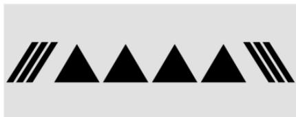
Si el ACC está activado, se puede requerir la acción del conductor cuando el ACC no puede aplicar suficiente frenado debido a que su vehículo se aproxima a un vehículo al frente demasiado rápido.
