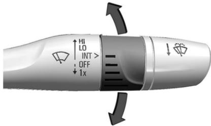
**INT** : Úselo para pasadas intermitentes o Rainsense, si está equipado y activado. Para ajustar la frecuencia de pasadas, gire la banda hacia arriba para limpiezas más frecuentes o hacia
