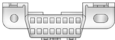
El DLC está debajo del tablero de instrumentos del lado izquierdo del volante. Conectar dispositivos que no se utilicen para realizar una Inspección de emisiones/Prueba de mantenimiento o para dar servicio al vehículo puede afectar la operación del vehículo. Vea *Equipo eléctrico incorporado* ⇨ 207. Visite a su distribuidor si necesita asistencia.
