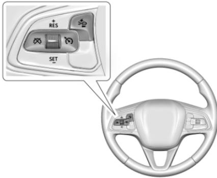
: Presione para encender o apagar el sistema ACC. La luz indicadora se vuelve blanca en el grupo de instrumentos al activarse el ACC.
