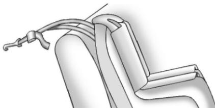
Si la posición que usa no tiene cabecera o reposacabezas y utiliza una atadura dual, dirija la atadura sobre el respaldo.
