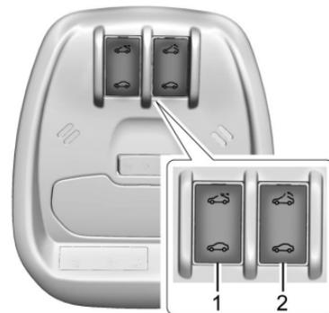
1. Interruptor de quemacocos (SLIDE/VENT-Deslizar/Ventilar)
