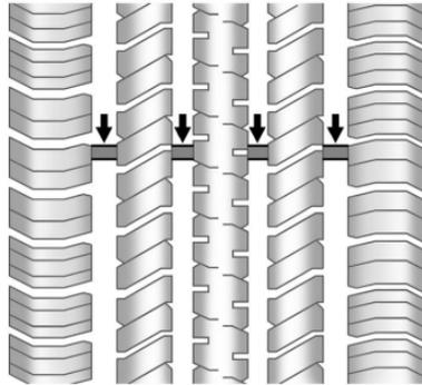
Los indicadores de desgaste del dibujo son una de las maneras de decidir cuándo es el momento para nuevas llantas. Los indicadores de desgaste aparecen cuando las llantas tienen solamente 1.6 mm (1/16 de pulgada) de dibujo remanente. Vea *Inspección de llantas* ⇨ 253 y *Rotación de la llanta* ⇨ 254.
