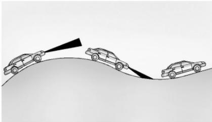
No utilice el ACC al conducir en colinas pronunciadas o al arrastrar un remolque, el ACC no detectará un vehículo en el carril al conducir en colinas pronunciadas. Si se aplican los frenos, como cuando se conduce cuesta abajo, el ACC se desactivará.
