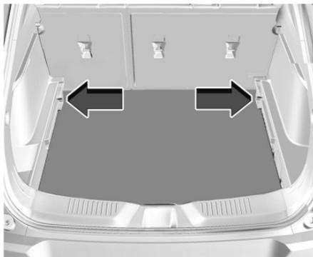
El sistema de administración de carga tiene un ajuste de ángulo para asegurar el piso de carga mientras se retiran los artículos almacenados.
