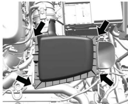
3. Retire los cuatro tornillos, incline la cubierta, y deslice el ensamble hacia afuera.
