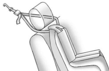
Si la posición que está utilizando tiene un reposacabezas o una cabecera y está utilizando doble correa, levante el reposacabezas o la cabecera y pase la correa por debajo del reposacabezas o de la cabecera así como alrededor de las barras del reposacabezas o de la cabecera.
