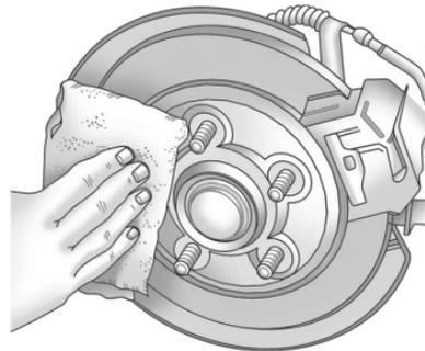
9. Elimine todo el óxido y la suciedad de los pernos de la rueda, las superficies de montaje y la rueda de refacción.
