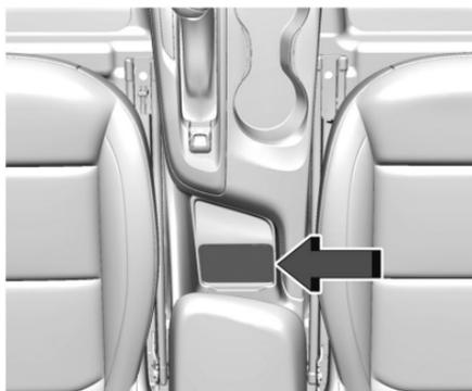
3. Retire las dos llaves remotas reconocidas de la cavidad de la llave remota. Coloque la nueva llave remota en la cavidad de la llave remota.
