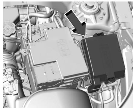
Para retirar la cubierta del bloque de fusibles, presione el seguro y levántela.
