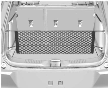
Este vehículo puede contar con una red de conveniencia en la parte trasera del vehículo. Fijela a los amarres para carga para guardar cargas pequeñas.
