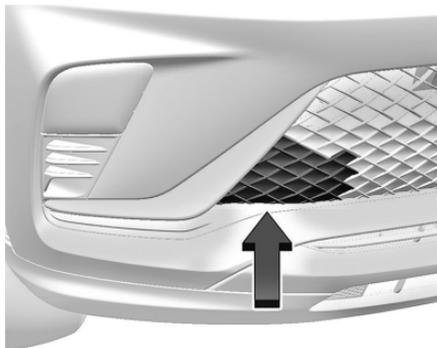
Abra cuidadosamente la cubierta en la fascia usando la ranura pequeña que guarda el receptáculo de la argolla de remolque.
