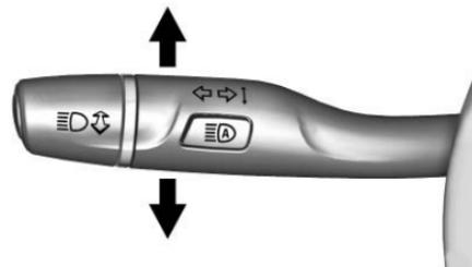
Mueva la palanca completamente hacia arriba o hacia abajo para señalar una vuelta.
