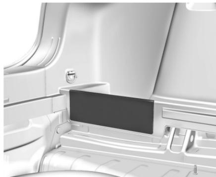
En el área de almacenamiento del compartimento trasero, el tablero de almacenamiento inferior del cuarto trasero se puede retirar en el lado del conductor. Levante el piso de carga para obtener acceso y jale el tablero para retirarlo.
