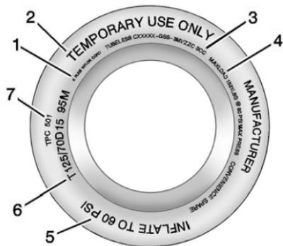
Ejemplo de llanta de refacción compacta
