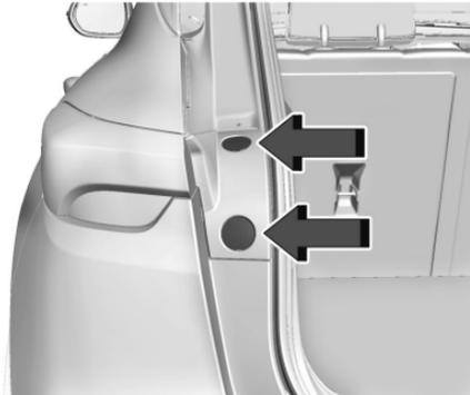
1. Retire y conserve ambos tornillos que sujetan el ensamblaje de la luz trasera a la carrocería del vehículo.
