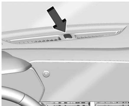
El vehículo tiene un sensor de luz en la parte superior del tablero de instrumentos. Asegúrese de que no está cubierto, o los faros se encenderán cuando no sean necesarios.
