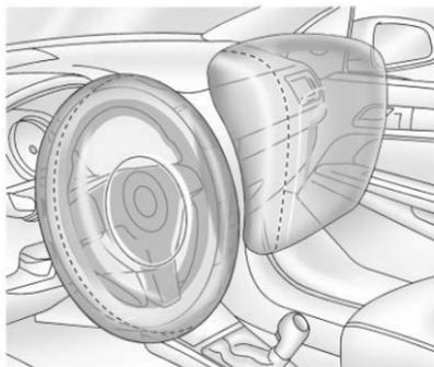
La bolsa de aire frontal del conductor está en el centro del volante de conducción.
