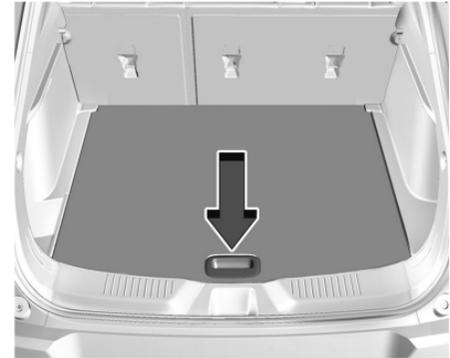
Levante el piso de carga para obtener acceso al sistema de administración de la carga.
