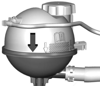
3. Llene el tanque de compensación del refrigerante con la mezcla adecuada hasta la marca de nivel indicado.
