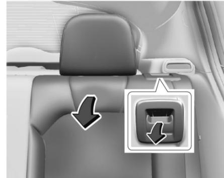
1. Jale la palanca en la parte superior del respaldo para desbloquear el respaldo. Un indicador rojo cerca de la palanca del respaldo está expuesto cuando el respaldo está destrabado.
