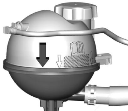
Revise si se alcanza a ver refrigerante en el tanque de compensación del refrigerante. Si el refrigerante que está dentro del tanque de compensación del refrigerante está hirviendo, no haga nada más hasta que se enfríe.
