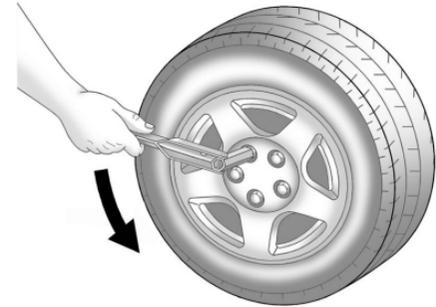
2. Haga girar la llave para las ruedas en sentido inverso al de las manecillas del reloj para aflojar las tuercas de la rueda. No las retire aun.
