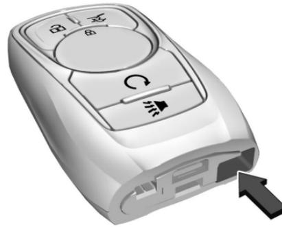
2. Inserte un objeto delgado y plano y retire la cubierta posterior.
