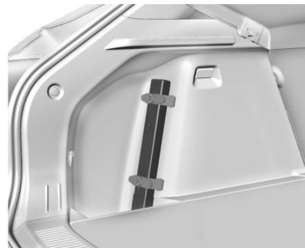
Si está equipado, el triángulo de advertencia se guarda en el compartimento de almacenamiento trasero.
