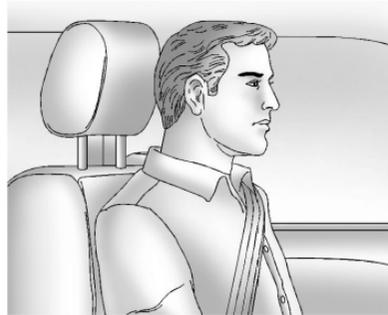
Ajuste las cabeceras de tal forma que la parte superior de la misma esté a la misma altura que la parte superior de la cabeza del ocupante. Esta posición reduce la probabilidad de una lesión de cuello durante un accidente.
