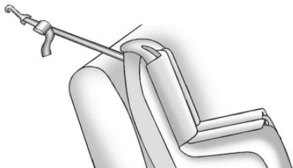
Si la posición que usa no tiene cabecera o reposacabezas y utiliza una atadura sencilla, dirija la atadura sobre el respaldo.
