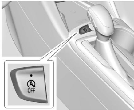
Si está equipado, la característica de paro/ arranque automático de motor se puede desactivar y activar presionando el interruptor con el símbolo
