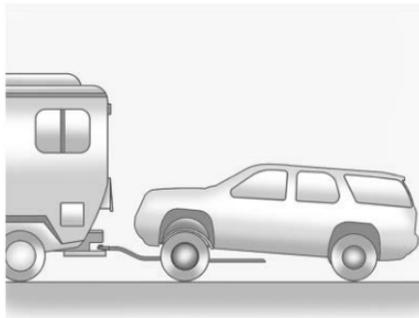
Para remolcar un vehículo de tracción delantera desde el frente, con dos ruedas en contacto con el suelo:
