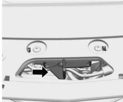
2. Vaya al frente del vehículo y mueva la palanca secundaria de liberación del cofre hacia el lado derecho del vehículo.
