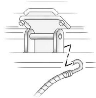
5. Baje la puerta trasera lo suficiente como para poder enganchar el cable en la parte exterior de las bisagras de la puerta trasera.
