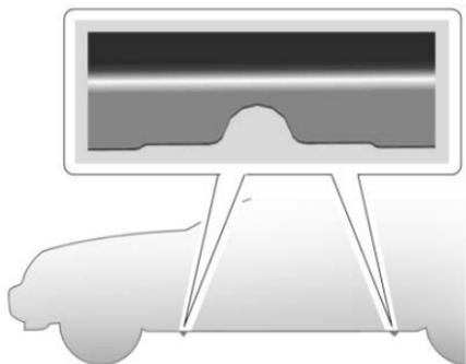
4. Coloque la cabeza de elevación del gato en el punto para colocación del gato que esté más cerca de la llanta pinchada.
