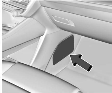
El bloque de fusibles del tablero de instrumentos está dentro de la columna central, en el lado del pasajero del vehículo.
