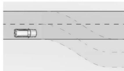
Super Cruise puede proporcionar ocasionalmente una alerta y/o dirección que se consideran innecesarios. Podría responder a marcas de carril en diferentes carriles, a señales, barandales y otros objetos estacionarios al entrar o salir de una curva. Esto es un funcionamiento normal. El vehículo no necesita servicio.
