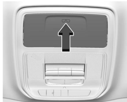
El almacenamiento de lentes para el sol está en la consola superior. Presione la cubierta y libere para tener acceso.
