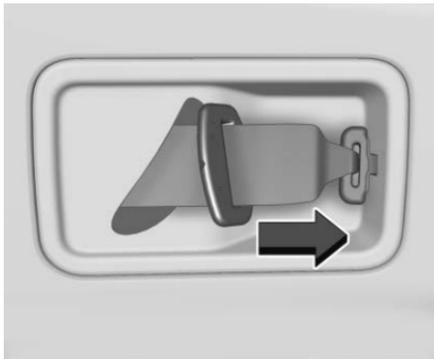
5. Deslice el seguro pequeño por el sujetador localizado en la capota interna.
