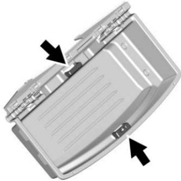
3. Levante las manijas sobre ambos lados para retirar el sistema de administración de carga para tener acceso a la llanta de refacción.
