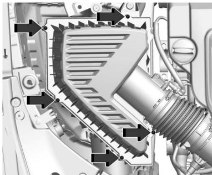
1. Retire los cinco tornillos y levante la cubierta del ensamble.
