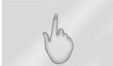
Nudge (vibración) se usa para mover los elementos una distancia corta en una lista o un mapa. Para nudge (vibración), sostenga y mueva el elemento seleccionado hacia arriba y abajo a una nueva ubicación.
