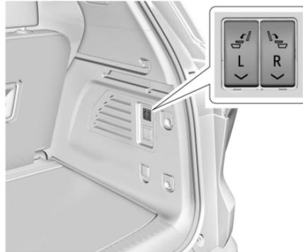
Si está equipado, presione el interruptor en la moldura lateral del área de carga para plegar el respaldo de segunda fila. El interruptor izquierdo pliega el respaldo del asiento izquierdo y el interruptor derecho pliega el respaldo del asiento derecho.
