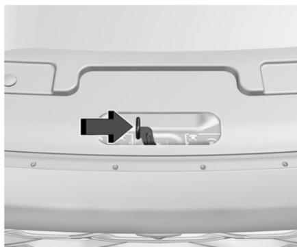
2. Vaya al frente del vehículo y localice la palanca de liberación secundaria debajo del centro delantero del cofre. Empuje la palanca de liberación secundaria del cofre a la derecha para liberar.
