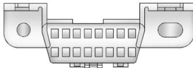
El DLC está debajo del tablero de instrumentos del lado izquierdo del volante. Conectar dispositivos que no se utilicen para realizar una Inspección de emisiones/Prueba de mantenimiento o para dar servicio al vehículo puede afectar la operación del vehículo. Vea *Equipo eléctrico incorporado* ⇨ 281. Visite a su distribuidor si necesita asistencia.
