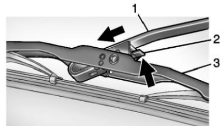
5. Empuje la palanca de liberación (2) para desacoplar el gancho y empuje el brazo del limpiador (1) hacia fuera del ensamblaje de la pluma (3).
