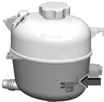
3. Llene el tanque de compensación del refrigerante con la mezcla adecuada hasta la marca de nivel indicado.
