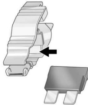
3. Use el extractor de fusibles para retirar el fusible de la parte superior o el costado.
