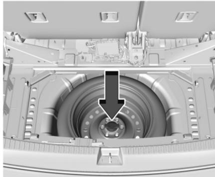
9. Si el vehículo no está equipado con un subwoofer, retire la tuerca de mariposa central, y después retire la llanta de refacción y colóquela al lado de la llanta que se está cambiando.
