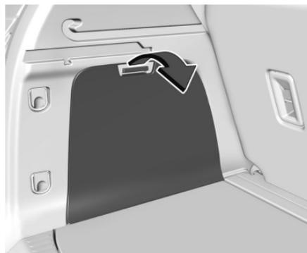
1. Si está equipado, es posible que haya un tablero exterior que deba retirarse para llegar al tablero interior. Presione el sujetador y jale el tablero hacia usted para retirarlo.
