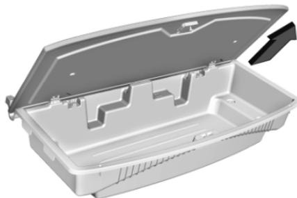
1. Retire el piso de carga. Abra el piso de carga aproximadamente 70% y jale hacia arriba y afuera para liberar los dos ganchos de la varilla fija al sistema de administración de carga.
