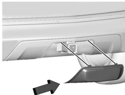
**Para retirar la cubierta del gancho, si está equipada:**
