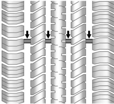
Los indicadores de desgaste del dibujo son una de las maneras de decidir cuándo es el momento para nuevas llantas. Los indicadores de desgaste aparecen cuando las llantas tienen solamente 1.6 mm (1/16 de pulgada) de dibujo remanente. Vea *Inspección de llantas* ⇨ 327 y *Rotación de la llanta* ⇨ 327.
