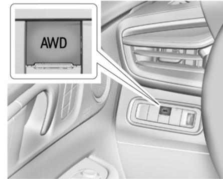
**Modo de Tracción en todas las ruedas:** El modo de Tracción en todas las ruedas proporciona torque de conducción a las cuatro ruedas. Seleccione el modo de Tracción en todas las ruedas para mejorar la tracción y control en superficies resbaladizas del camino, como grava, arena, pavimento mojado, nieve y hielo.
