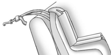
Si la posición que usa no tiene cabecera y utiliza una atadura doble, dirija la atadura sobre el respaldo.
