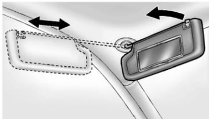
Tire de la visera hacia abajo para bloquear el resplandor. Desconecte la visera del montaje central para pivotarla a la ventana lateral y, si está equipado, para extenderla a lo largo de la varilla.
