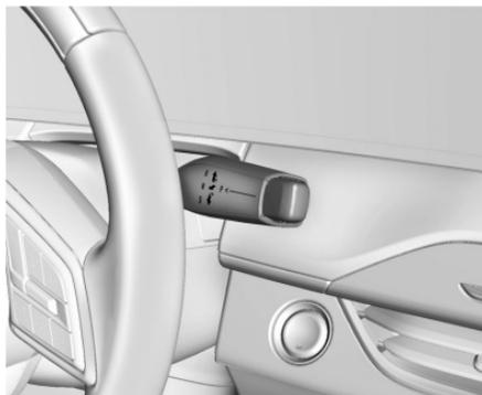
El patrón de cambios se muestra en la parte delantera de la palanca de cambios. La posición de velocidad seleccionada se iluminará en rojo en la palanca de cambios, mientras que todas las demás se proyectarán en blanco. Si el cambio no es inmediato, como en condiciones muy frías, el indicador en el interruptor de cambios puede parpadear hasta que esté completamente conectado.
