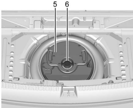
7. Si el vehículo está equipado con un subwoofer (5), retire la tuerca de mariposa central (6), y después retire el subwoofer y colóquelo a un lado. No desconecte el arnés de cableado.
