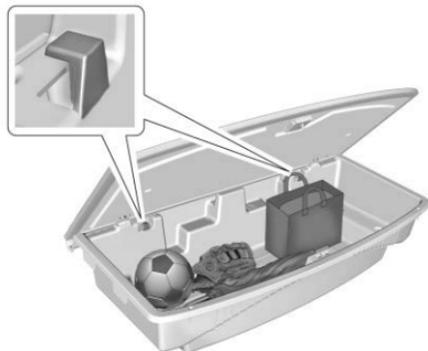
El sistema de administración de carga se usa para organizar el almacenamiento en el área de carga. Hay dos ganchos de conveniencia que pueden soportar hasta 5 kg (11 lbs).
