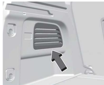
2. El tablero interior se retira haciendo palanca a lo largo del borde superior del tablero de moldura. Retire el tablero de moldura para tener acceso al bloque de fusibles, o consulte a su distribuidor.
