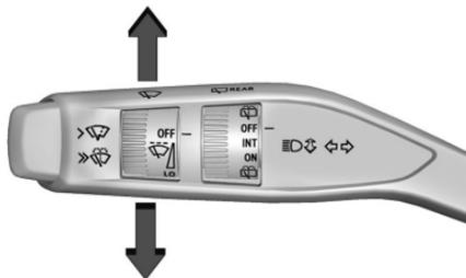
Mueva la palanca completamente hacia arriba o hacia abajo para señalar una vuelta.
