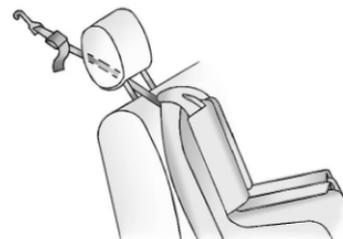
Si la posición que está utilizando tiene una cabecera ajustable y está utilizando sólo una atadura, levante
