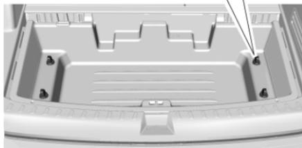
3. Retire las cuatro tuercas de mariposa y después retire el sistema de administración de carga. Vea *Sistema de administración de la carga* ⇨ 85.
