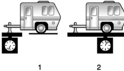
El peso de la lengüeta de remolque (1) debe ser 10–15 % del peso total del remolque cargado (2). Algunos tipos de remolques específicos, como remolques de bote, están fuera de estos rangos. Consulte el manual de propietario del remolque para el peso de lengüeta de remolque recomendado para cada remolque. Nunca exceda las cargas máximas para su vehículo, gancho y remolque.
