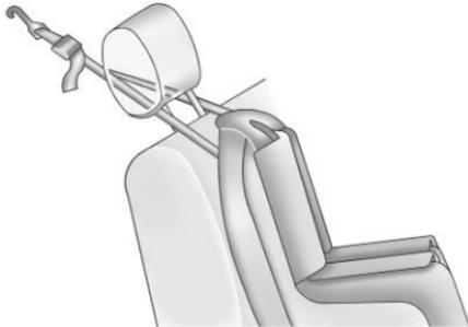
Si la posición que está utilizando tiene una cabecera ajustable y está utilizando una atadura doble, eleve la cabecera y tienda la atadura alrededor de los postes de la cabecera.
