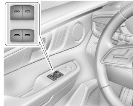
Las ventanas eléctricas funcionan cuando el vehículo está encendido, en modo de accesorios, o cuando la Energía retenida para
