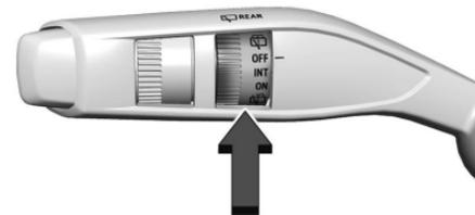
Los controles del limpiador/lavador de la ventana trasera se encuentran en el extremo de la palanca del limpiaparabrisas.
