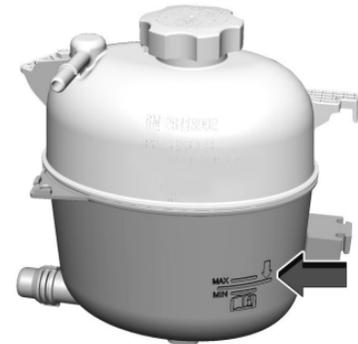
Revise si se alcanza a ver refrigerante en el tanque de compensación del refrigerante. Si el refrigerante que está dentro del tanque de compensación del refrigerante está hirviendo, no haga nada más hasta que se enfríe. Si el refrigerante está visible pero la marca de nivel de refrigerante no lo está, agregue una mezcla 50/50 de agua limpia y potable con refrigerante DEX-COOL en el
