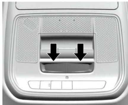
Oprima las lentes de la lámpara para encender o apagar las luces de lectura delanteras.
