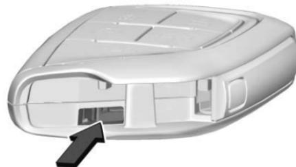
2. Separe las dos mitades de la llave remota utilizando la hoja de la llave mecánica insertada en el centro inferior de la llave remota. No use la ranura de la llave.
