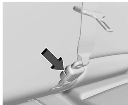
4. Desconecte el seguro pequeño del cinturón de seguridad central, utilizando una llave en la ranura del broche pequeño, y permita que el cinturón se retraiga en la capota interna.
