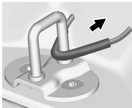
8. Asegúrese de que el tubo metálico esté centrado en la placa de la cerradura. Empuje el tubo hacia el frente del vehículo.
