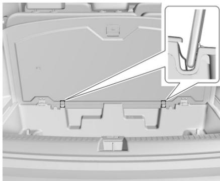
Los dispositivos de retención en el contenedor de carga permiten que el piso de carga permanezca abierto sin necesidad de removerlo.
