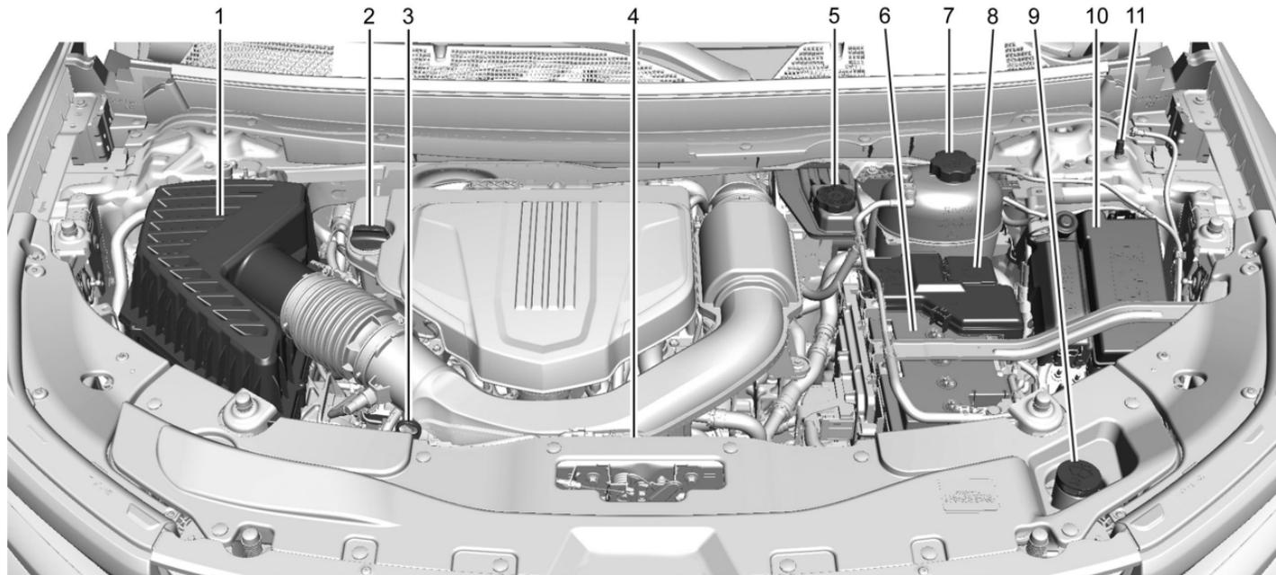
1. Filtro de depurador de aire del motor. Vea *Depurador/filtro de aire motor* ⇨ 291.
