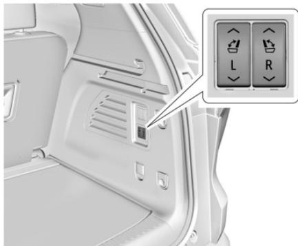
Si está equipado, los respaldos de la tercera fila también se pueden plegar hacia adelante y volver a la posición vertical presionando sin soltar los interruptores en el lado del pasajero del área de carga trasera.
