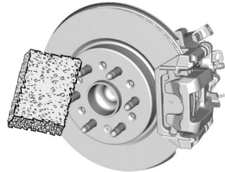
10. Elimine todo el óxido y la suciedad de los pernos de la rueda y las superficies de montaje y la rueda de refacción.
