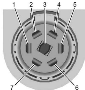
Si el vehículo no está equipado con un conector de remolque de siete clavijas, el arnés de la carrocería tiene preparativos para conectar un arnés de remolque y un conector de remolque de siete clavijas que está disponible a través del distribuidor.
