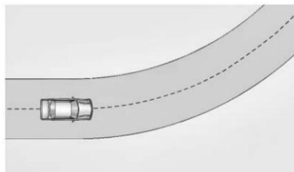
Al ingresar a una curva, Super Cruise puede no detectar las marcas del carril y puede no ajustar la dirección lo suficiente como para permanecer en su carril de circulación. Cuando esto suceda, deberá dirigir el vehículo.
