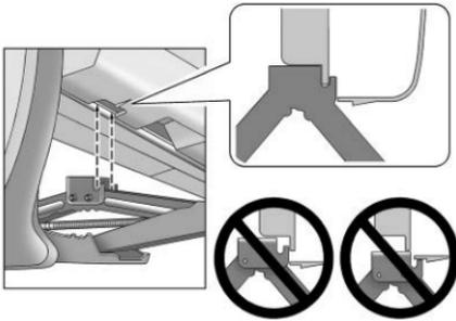
5. Gire la llave para ruedas en el sentido de las manecillas del reloj para levantar la cabeza de elevación del gato hidráulico hasta que las ranuras en la cabeza del gato hidráulico se ajusten en la brida metálica detrás del corte en la moldura de plástico. Aún no eleve el vehículo.
