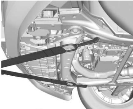
El vehículo está equipado con puntos de conexión específicos que serán usados por el proveedor de remolque. Estos orificios se pueden usar para jalar el vehículo desde una superficie de camino plano sobre el camión de remolque de plataforma plana.
