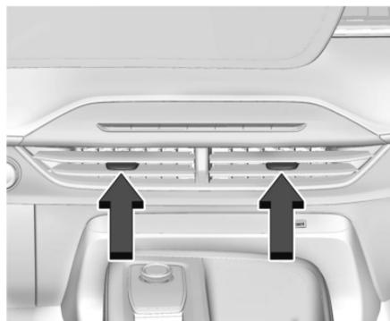
Mueva las perillas centrales sobre las salidas de aire para abrir o cerrar el flujo de aire.
