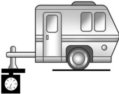
El peso de lengüeta de remolque contribuye al peso bruto vehicular (GVW). El GVW incluye el peso en vacío de su vehículo, cualquier pasajero, carga, equipo, y el peso de la lengüeta del remolque. Las opciones del vehículo, pasajeros, carga y equipo reducen el peso de lengüeta máximo permisible que puede transportar el vehículo, que también reduce el peso máximo permisible del remolque.
