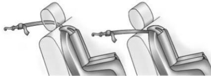
Si la posición que utiliza tiene una cabecera fija y está utilizando una sola atadura, tienda la atadura debajo de la cabecera y entre los postes de la cabecera o alrededor del lado exterior de la cabecera.
