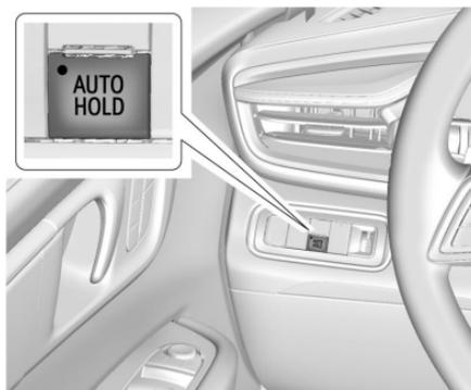
Cuando se activa el Sostenimiento automático del vehículo (AVH) y se frena el vehículo, AVH evita que el vehículo se mueva durante la transición de la liberación del pedal del freno al pedal del acelerador. Los frenos se liberan cuando se aplica el pedal del acelerador. Los frenos también se pueden liberar bajo otras condiciones. No confíe plenamente en AVH para sostener el vehículo.
