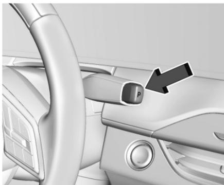
**P:** Esta posición bloquea las ruedas motrices. Use P (Estacionamiento) cuando arranque el vehículo para asegurarse que el vehículo no se mueva.
