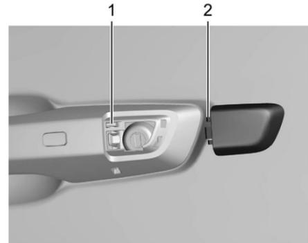
1. Coloque el borde inferior de la tapa debajo del borde inferior de la pieza metálica. Las lengüetas (2) se fijan a la pieza metálica en las posiciones (1).
