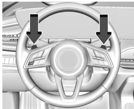
La Selección electrónica de rango (ERS), o modo manual, permite la selección del rango de posiciones de las velocidades. Utilice este modo
